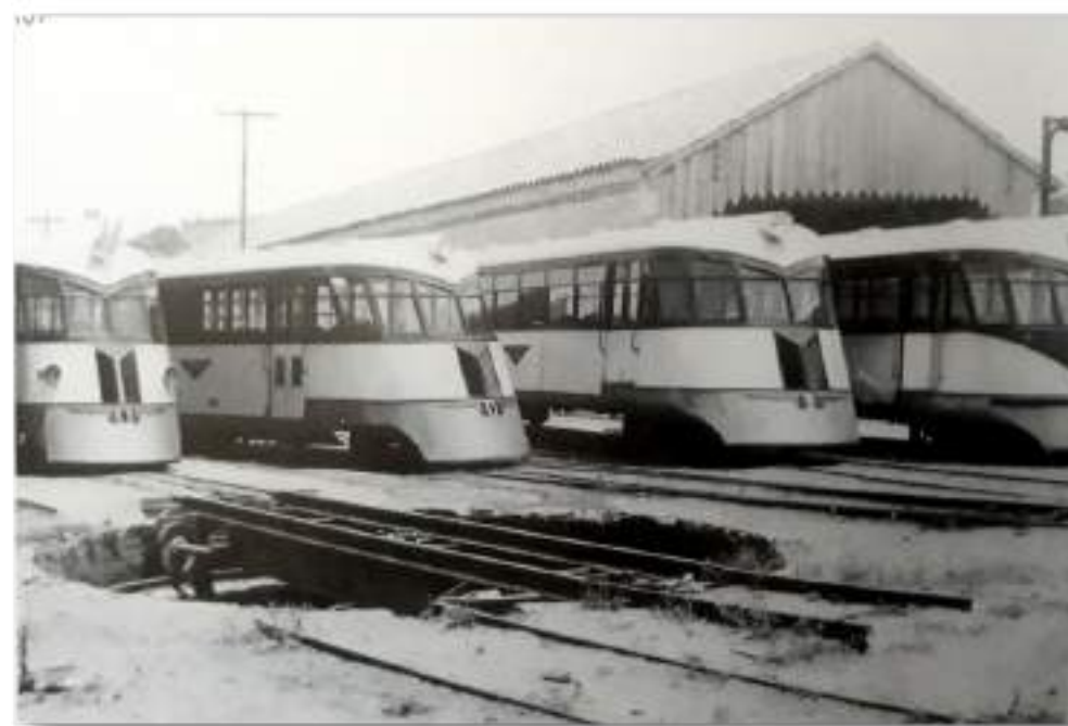
Carros motores construídos pela Viação Férrea do Rio Grande do Sul (VFRGS) na década de 1930, nas oficinas de Santa Maria-RS. Na frente dos veículos vemos um girador.
